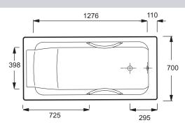
Спецификация продукта: Ванна 150 x 70 см с отверстиями для ручек. E2949. Коллекция: PARALLEL. PA3MEPЫ (СМ): 150 x 70 x 45 см. BEC: 85 кг. МАТЕРИАЛ: Чугун. ТИП УСТАНОВКИ: Встраиваемые. ОБЪЕМ: 166/96. ФОРМА: Прямоугольные. ДИАМЕТР СЛИВА: 5.2 см. ДОПОЛНИТЕЛЬНАЯ ИНФОРМАЦИЯ: Установка к стене. НОЖКИ: Не в комплекте. СТУПЕНЬКА: Не в комплекте. СЛИВ: Не в комплекте. Размеры основания: 100 x 40 см. С отверстиями для ручек.
